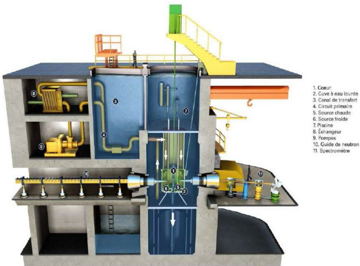
Vue éclatée du bloc pile d'Orphée
