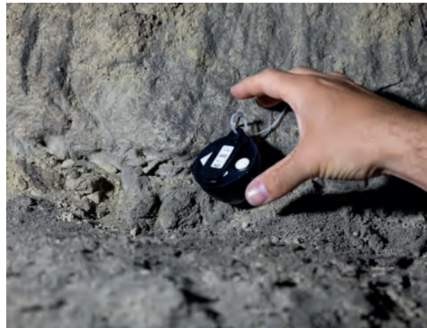
Pose de détecteurs radon dans une cave viticole.
