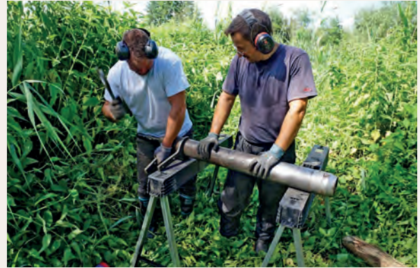
Extraction d'une archive sédimentaire sur les berges de la Meuse en aval de la centrale nucléaire de Chooz.
